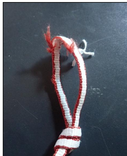
photo 19: Sangle endommagée après utilisation autour d'un goujon.
